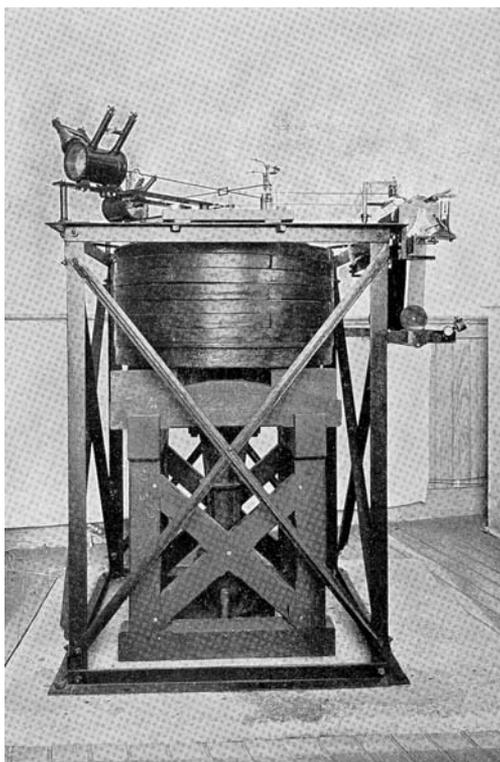
Figura 2.8.21.—Sismógrafo Wiechert astático reformado del Observatorio de Toledo (de [Rey32a]).
