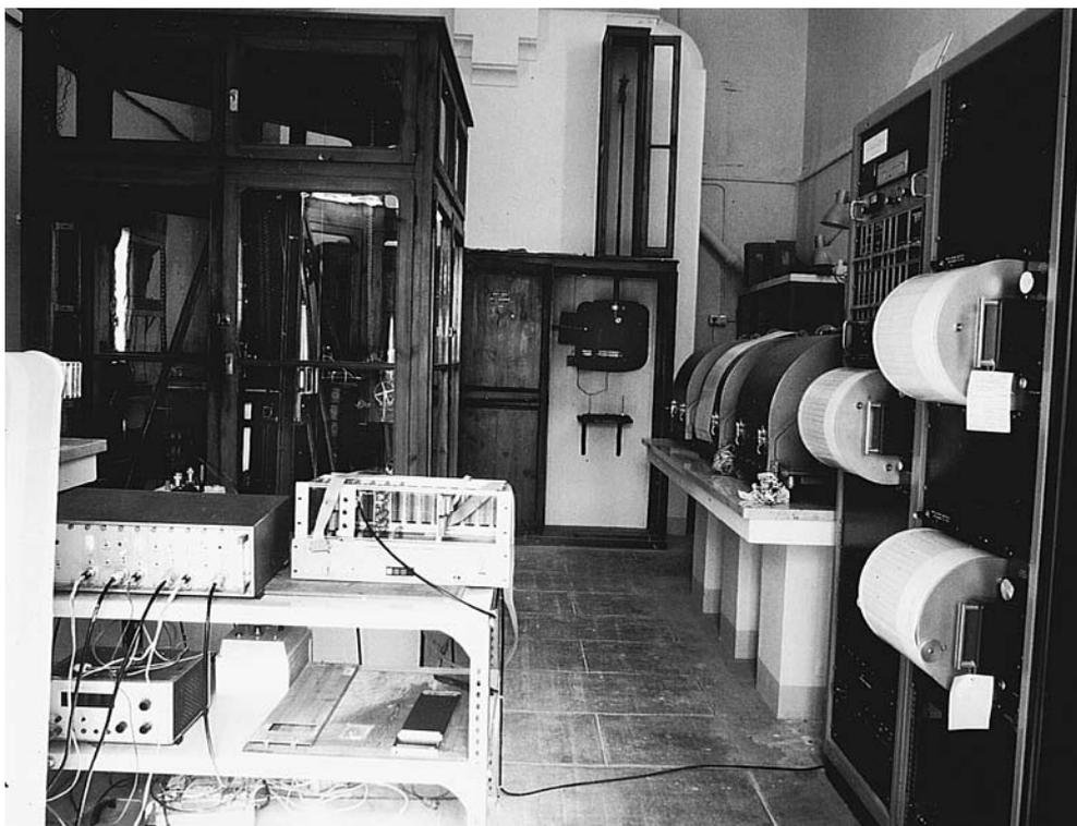
Figura 2.5.20.—Sala de registro del Observatorio Fabra en una fotografía actual. A la derecha pueden verse los tambores de registro de los instrumentos Teledyne-Geotech actuales y, detrás suyo, los registradores Askania correspondientes a los sismómetros Hiller-Stuttgart (fotografía de J. E. Buxeda).
