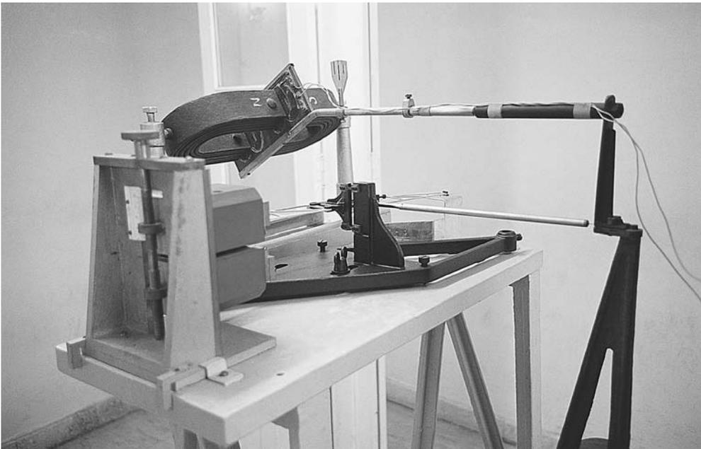
Figura 2.6.24.—En los talleres del Observatorio de Málaga se construyó una copia del mismo sistema electromagnético para el Wiechert vertical del Observatorio de Oporto y aquí reproducimos una imagen de esta parte del equipo (fotografía de J. Batlló).
