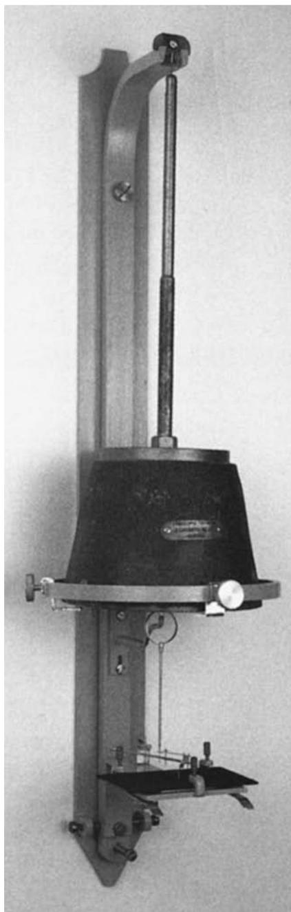
Figura 2.10.2.—No disponemos de ninguna fotografía de este aparato. Reproducimos aquí un sismoscopio Vicentini reconstruido en Italia durante la ejecución del proyecto TROMOS (de [Fer92b]).
