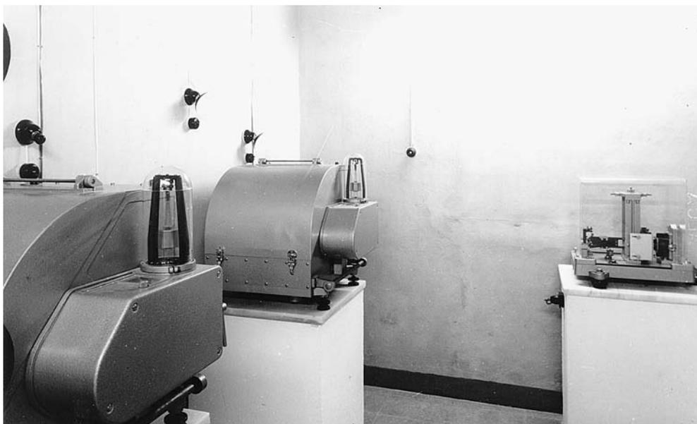
Figura 2.2.22.—Sismómetro Hiller-Stuttgart vertical instalado en el Observatorio de Almería (derecha) y dos tambores originales (construidos por Askania) de registro fotográfico de estos instrumentos (izquierda). Esta fotografía puede datarse en los primeros años sesenta (fotografía conservada en el Observatorio de Almería). Véase también la figura 2.3.59.
