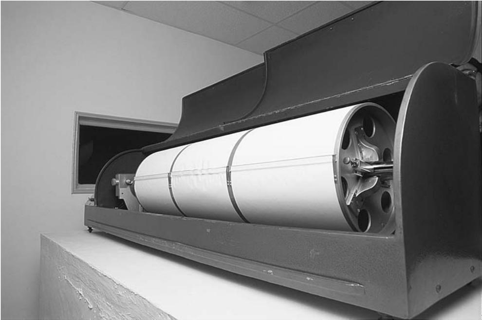
Figura 2.6.32.—Tambor de registro fotográfico para tres componentes. Estos tambores se utilizaron tanto para los sensores Benioff como para los Sprengnether que conformaban las estaciones de la WWSSN. El tambor de la imagen se encuentra en el Observatorio de Toledo (fotografía del archivo del IGN).
