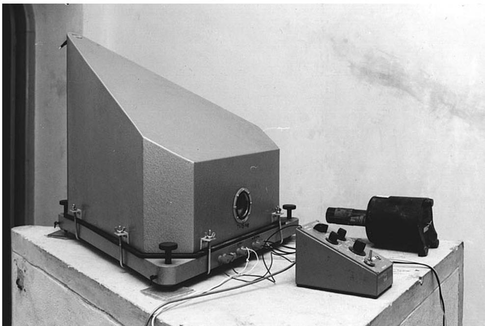
Figura 2.4.28.—Sismógrafo Sprengnether S-5000 H, componente N-S, instalado en el Observatorio del Ebro. A la derecha, un sensor Ranger SS-1. En primer plano, la caja de resistencias, que sirve para variar el amortiguamiento del sismómetro y el galvanómetro (fotografía J. Nieva). Véase también la figura 2.8.44.
