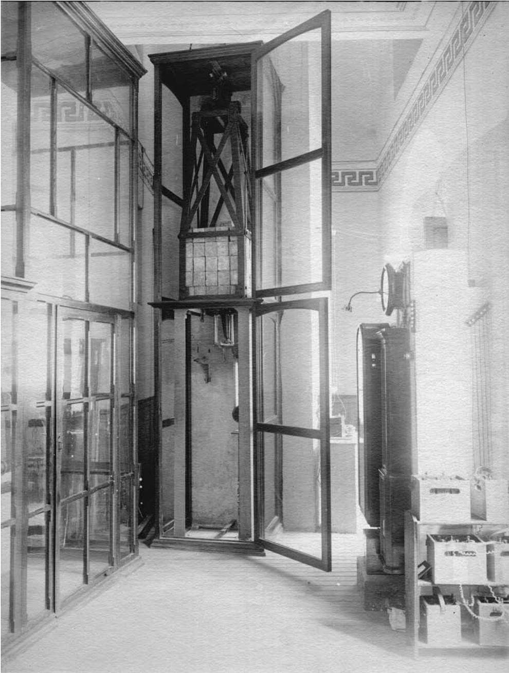
Figura 2.8.7.—Microsismométrógrafo Agamennone de 2000 kg de masa. A la izquierda, la vitrina para el microsismógrafo Vicentini (fotografía conservada en el Observatorio de Toledo).
