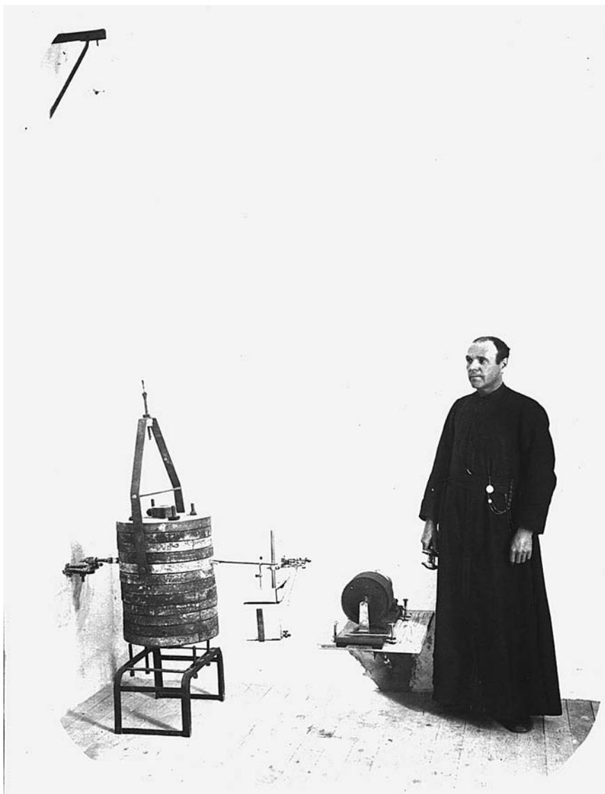
Figura 2.3.20.—Sismógrafo Cartuja bifilar de 425 kg de masa. A la derecha un hermano jesuita (creemos que Antonio Parra, artífice mecánico de algunos de los aparatos construidos y modificados en esos años). Fotografía conservada en el archivo del Observatorio del Ebro.
