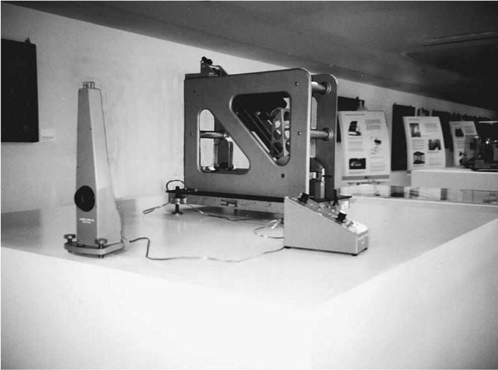
Figura 2.1.25.—Sismómetro Sprengnether S-5000 V vertical de período largo del Observatorio de Alicante, con su caja de resistencias y galvanómetro, durante una exposición de instrumentos celebrada en Valencia. El sensor se encuentra desprovisto de su cubierta externa (fotografía de J. Batlló). Véase también la figura 2.4.30.
