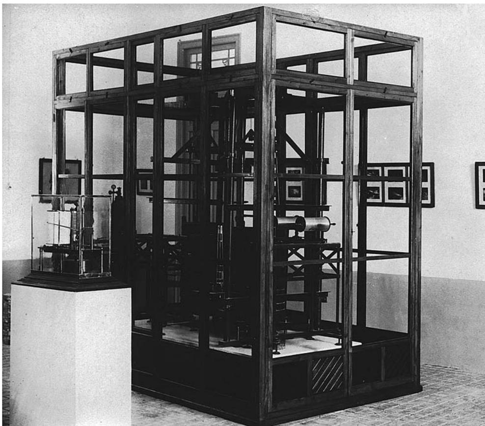
Figura 2.1.13.—Sismógrafos Mainka. La componente E-W se halla a la derecha. El pilar situado al frente, a la izquierda, sostiene un barógrafo (fotografía conservada en el Observatorio de Alicante). Véase también la figura 2.1.17.
