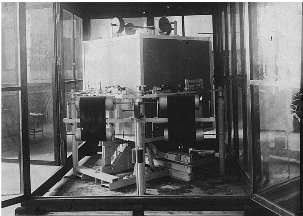
Figura 2.3.38.—Otra imagen del sismógrafo Berchmans del Observatorio de Cartuja (fotografía conservada en el archivo del Observatorio del Ebro).
