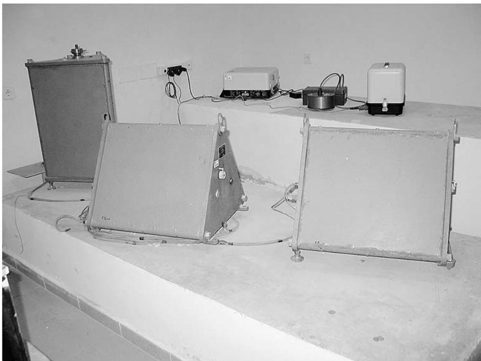
Figura 2.6.30.—En primer plano, conjunto de sensores Benioff, horizontales y vertical, instalados en el Observatorio de Málaga (fotografía de A. Henares).
