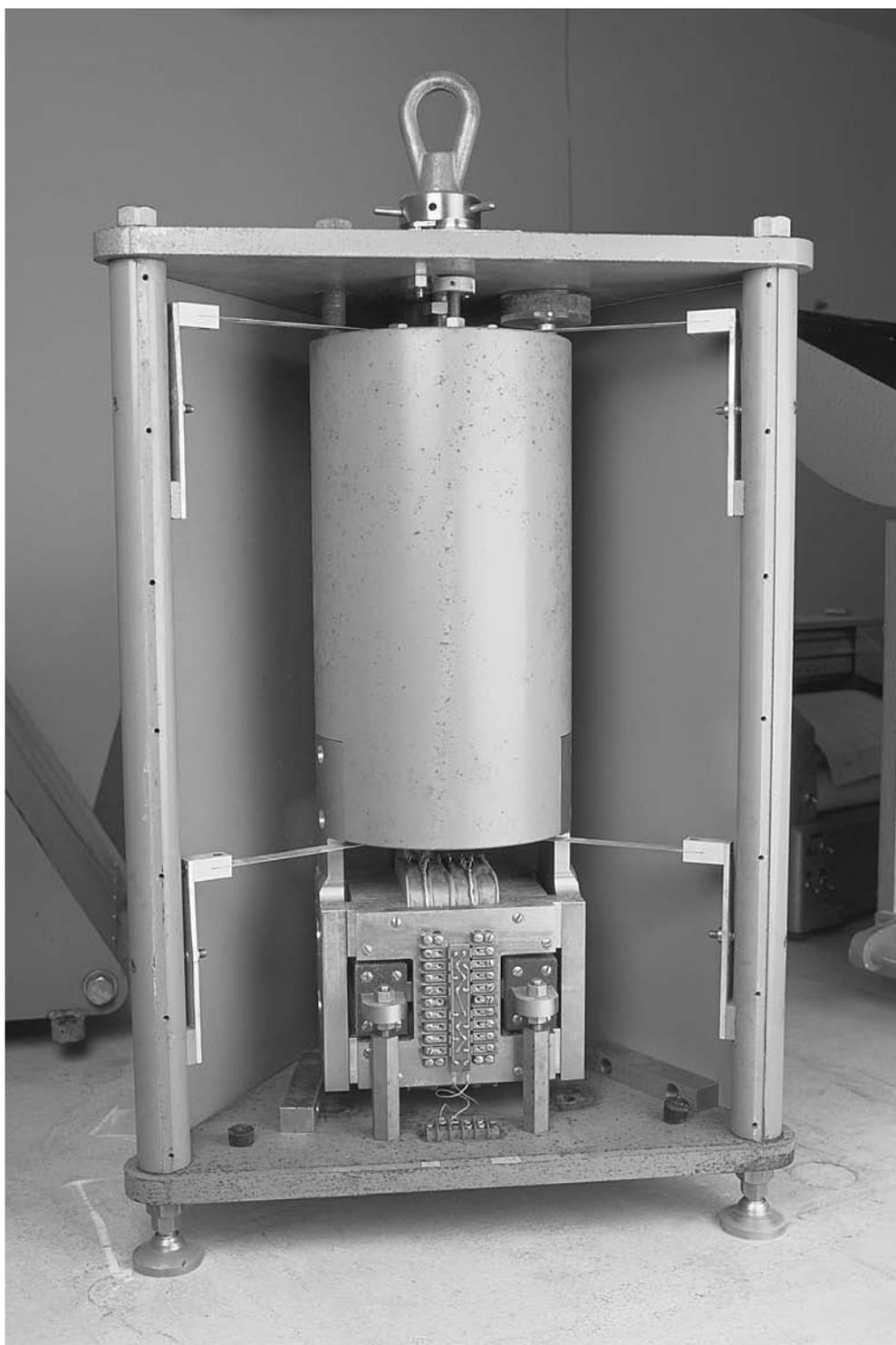
Figura 2.8.46.—Fotografía actual del sismómetro vertical Benioff, serie 1051, instalado en el Observatorio de Toledo (archivo del Instituto Geográfico Nacional).
