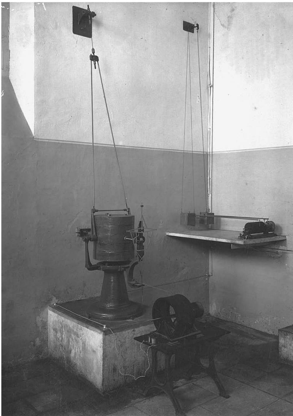
Figura 2.4.4.—Sismógrafos Grablowitz (derecha) y Mainka E-W (izquierda). Circa 1915 (fotografía conservada en el archivo del Observatorio del Ebro).
