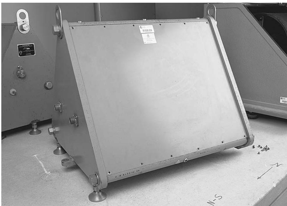
Figura 2.8.48.—Fotografías actuales de un sismómetro horizontal Benioff, serie 1101, instalado en el Observatorio de Toledo (archivo del Instituto Geográfico Nacional).
