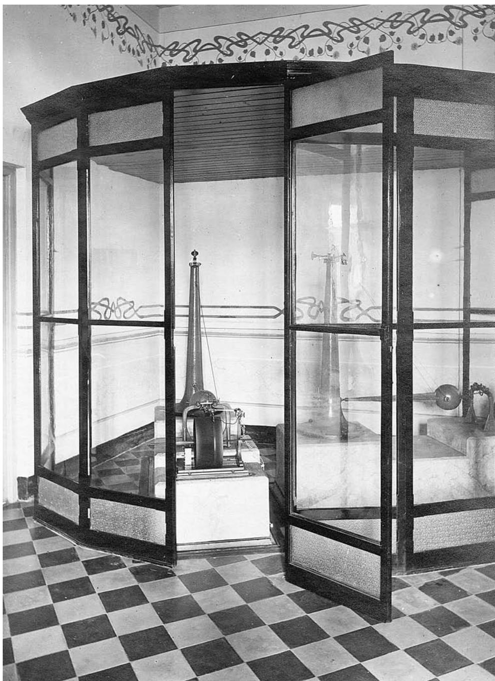
Figura 2.6.6.—Sismógrafos Bosch-Omori E-W (centro) y N-S (derecha) instalados en el Observatorio de Málaga (fotografía conservada en el archivo de la Subdirección General de Geofísica y Geodesia, IGN. Madrid).
