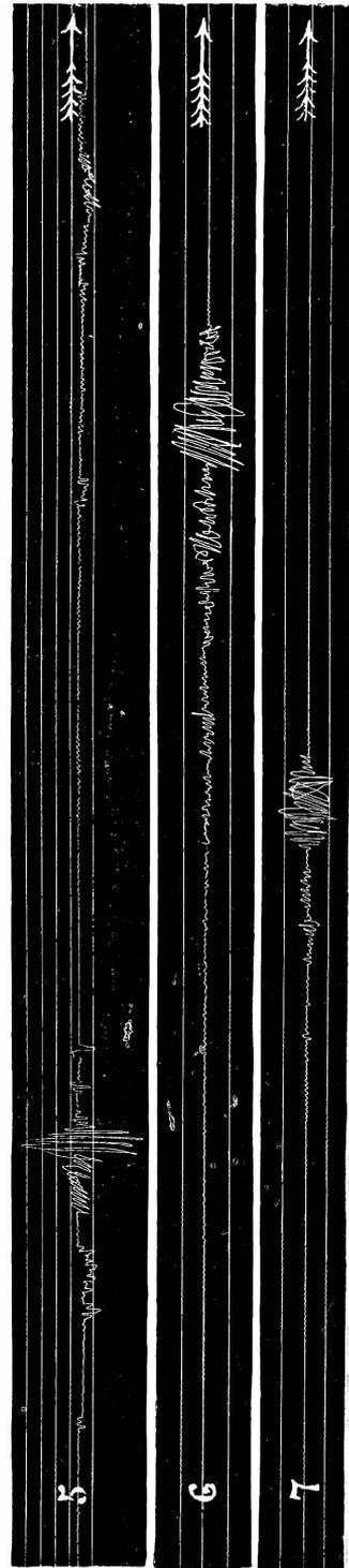
Figura 2.3.26.—No disponemos de ninguna fotografía de este instrumento. En su lugar, mostramos el curioso aspecto que ofrecían los registros del microsismógrafo Vicentini-Pacher, aquí para terremotos del año 1903. Las dos componentes del movimiento horizontal se registraban con una única traza (del *Boletín Mensual del Observatorio de Granada*, 1904-enero).
