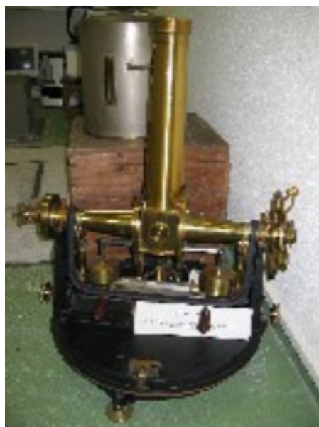
Anteojo de Pasos para determinación de la longitud
