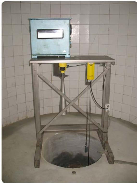
**Registrador mecánico, codificador digital y sensor radar**
