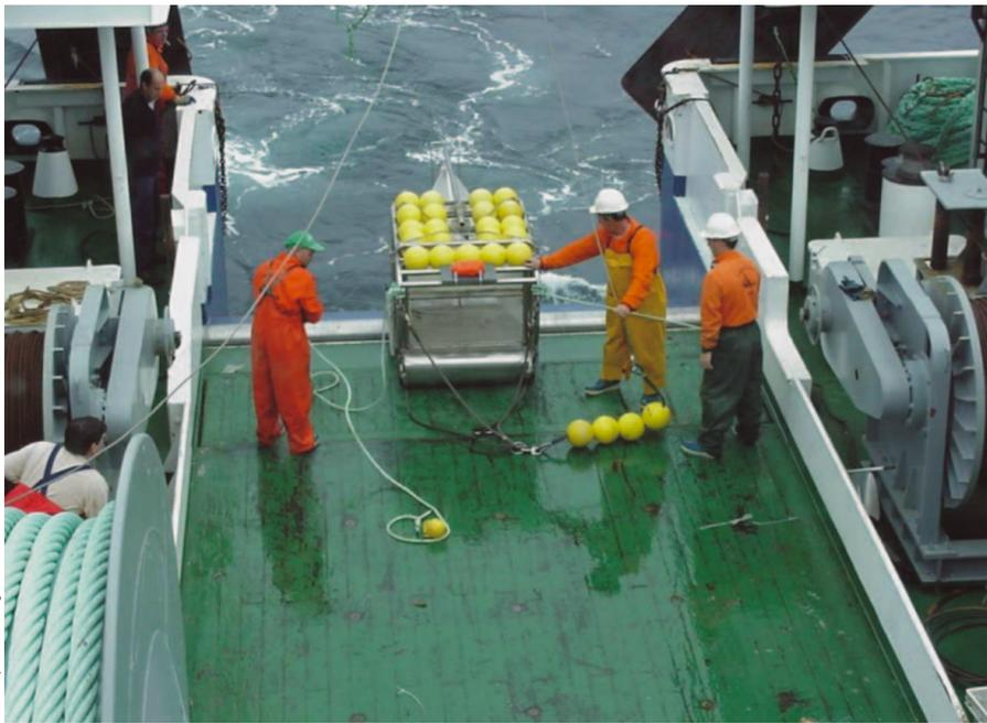
Trineo fotogramétrico en la rampa del buque oceanográfico Vizconde de Eza
