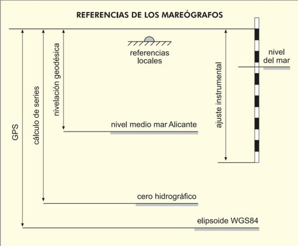
Esquema de los sistemas de referenciación de un mareógrafo
