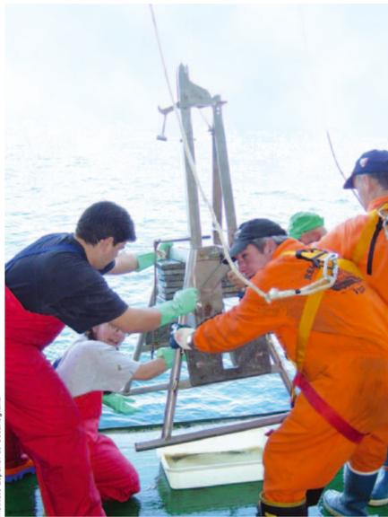
Draga «Box-Core», utilizada para coger muestras del fondo marino en las áreas de sedimentos
