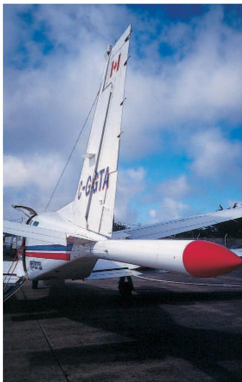
Magnetómetro de vapor de cesio Scintrex en «aguijón»
