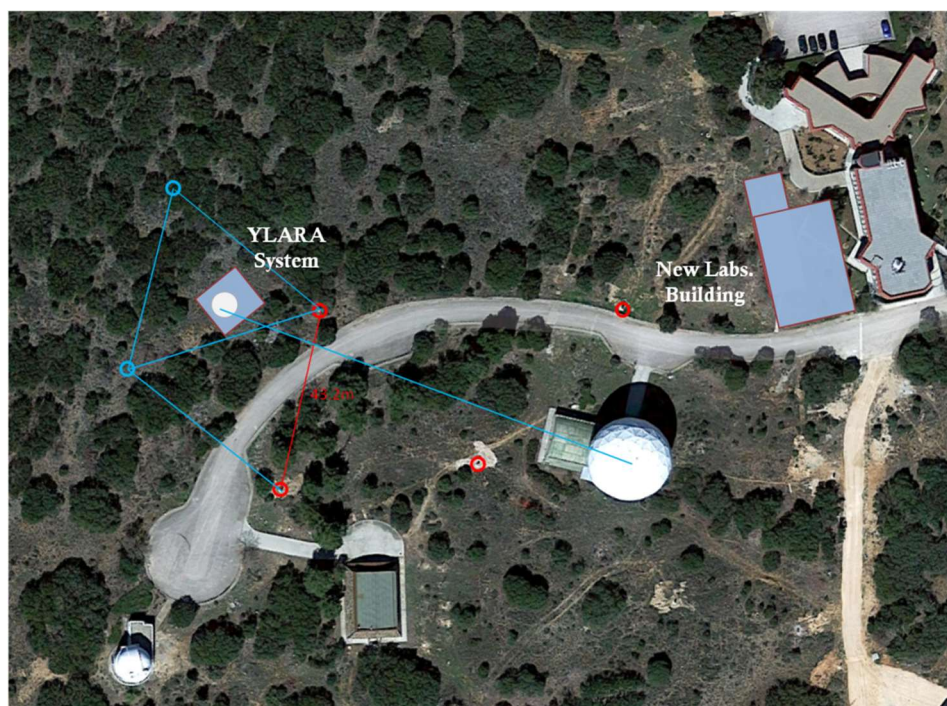
Figura 2. Emplazamiento aproximado de la estación SLR dentro del Observatorio de Yebes y localización de los pilares geodésicos más cercanos.
