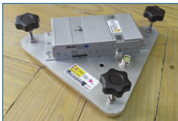
Acelerómetro SILEX basado en tecnología MEMS, de bajo coste, desarrollado por el IGN
