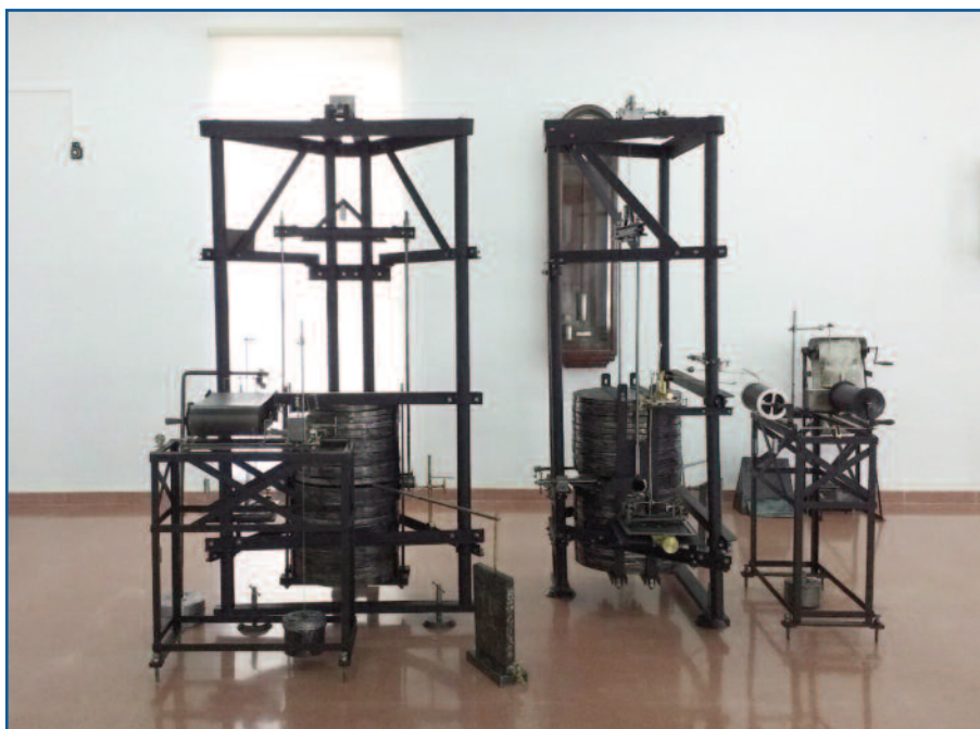
Sismógrafos Mainka Horizontales restaurados en el Observatorio Geofísico de Toledo
