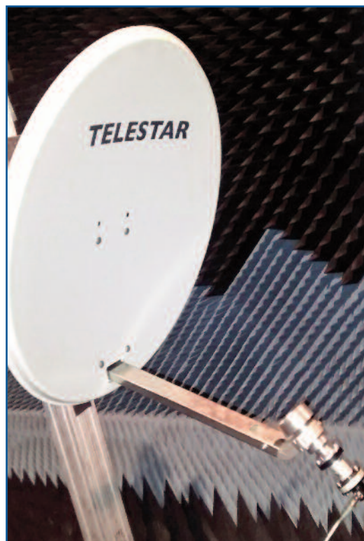
Se muestra la nueva antena de holografía (abajo a la derecha) apuntando a una antena comercial en la cámara anecoica
