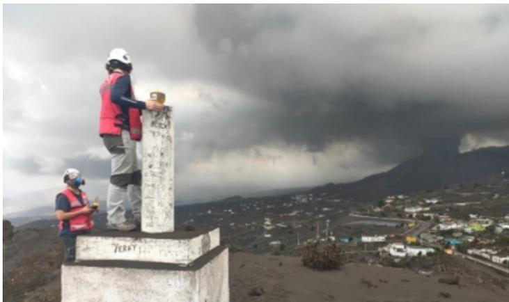
Medidas de deformación en la red RTK
