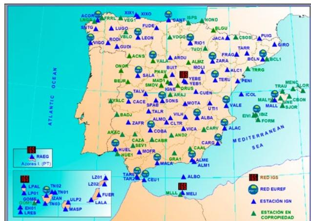
Red de Estaciones Permanentes GNSS del IGN (ERGNSS)
