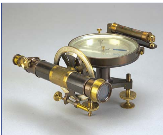
Brújula topográfica modelo J. Berdala del año 1910
