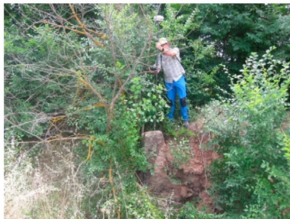
Replanteo en campo del mojón 11 en la línea límite firmada entre La Solana y San Carlos del Valle.
