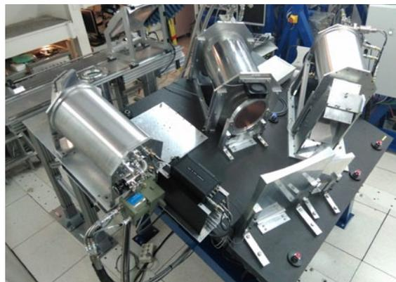
Mesa con los receptores de *Nanocosmos* en la cabina del radiotelescopio de 40 m. El sistema de calibración, visible en la esquina superior izquierda, también ha sido diseñado y fabricado a lo largo de este proyecto.
