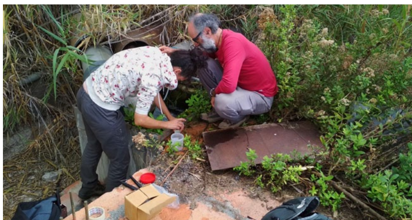
Personal del IGN y del INGV, tomando muestras de agua y gases disueltos en una galería en Tenerife.
