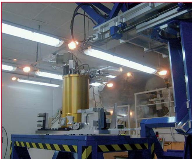
*Receptor de banda W (80-120 GHz) instalado en la cabina de receptores del radiotelescopio de 40 m*
