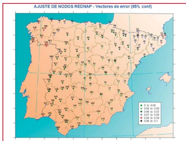
Figura 2. Distribución espacial de los vectores de error del ajuste (95% confianza).
