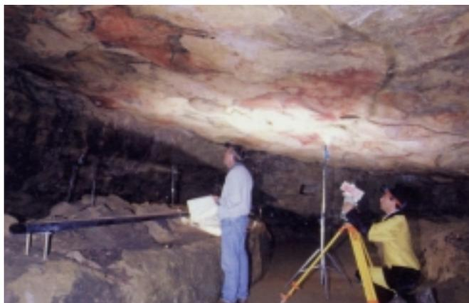
gran parte de la sala de polícromos tiene una altura del orden de un metro, teniendo que trabajar totalmente tumbados con la cámara apoyada directamente sobre el suelo. Para el apoyo fotogramétrico se tomaron 70 puntos del techo de polícromos desde varias estaciones.
