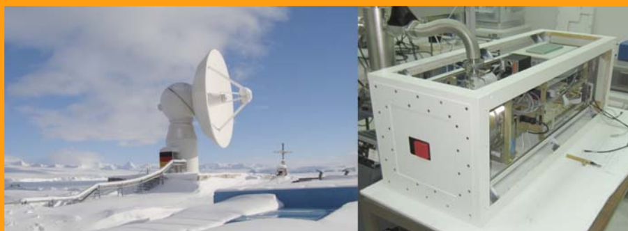
Radiotelescopio del BKG en O'Higgins (Antártida) y receptor criogénico actualizado y mejorado en el Observatorio de Yebes
