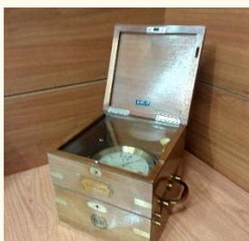
Los cronómetros de longitud o marinos, eran instrumentos de gran precisión diseñados para el cálculo de longitud geográfica en la navegación. Median la diferencia entre la hora local (determinada por el sextante) y la hora marcada y conservada por el reloj correspondiente a un meridiano de referencia. La variación de la marcha en un segundo originaba una imprecisión en el cálculo de la longitud geográfica en 464 metros referida al ecuador.
