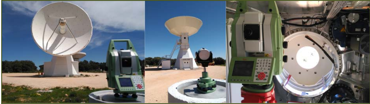
Medida del punto invariante del radiotelescopio de 13.2m de RAEGE en Yebes
