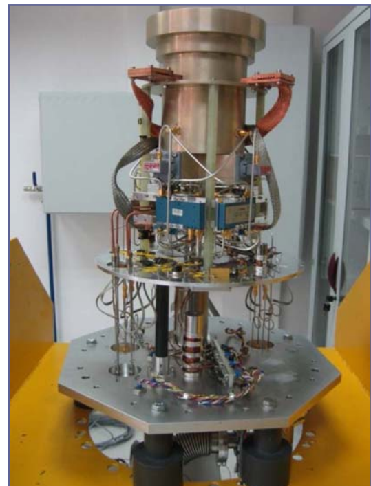
Receptor tribanda desarrollado para el Instituto GSI de Japón
