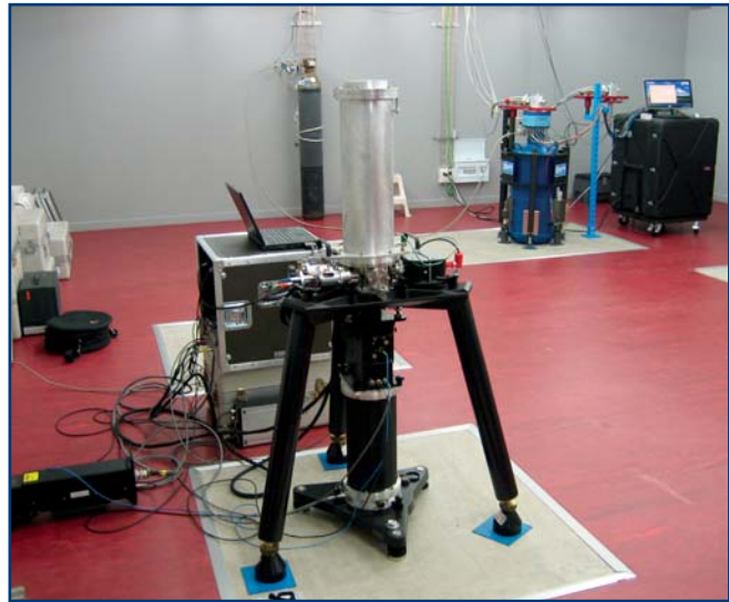
Recinto interior del Pabellón de Gravimetría: a la izquierda, el gravímetro absoluto FG5; al fondo el nuevo gravímetro superconductor
