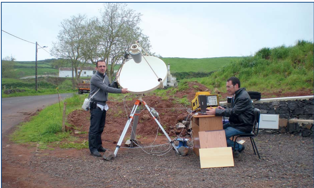
Sistema de medida de interferencias durante las medidas en Fontes do Jordão (Islas Azores) a 44 grados de elevación
