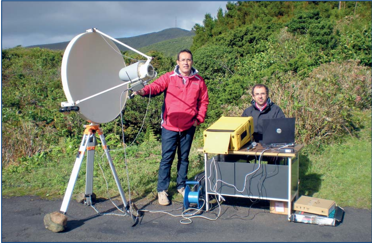
Equipo de medida de interferencias radioeléctricas
